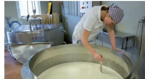
Die Bruchkonsistenz wird geprüft.
